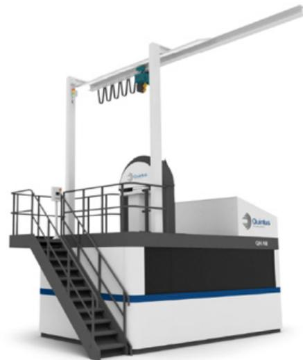
*La machine à Compression Isostatique à Chaud, installée à l'intérieur de CALHIPSO*
